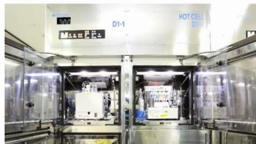
図2. PET薬剤の製造に用いられる自動合成装置とホットセル
